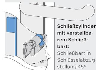
**Schließzylinder mit verstellbarem Schließbart:**
