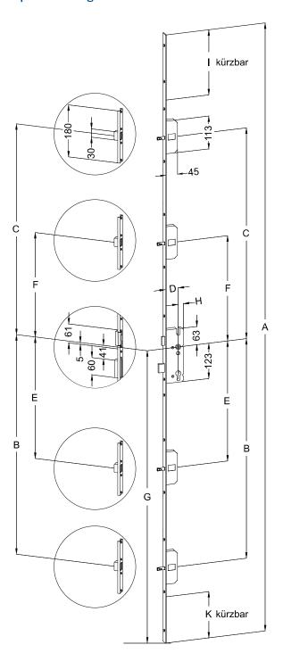
solidLock von Winkhaus gewährt hohe Sicherheit mit robuster Technik. Egal ob Kunststoff, Holz oder Aluminium, mit der angepassten Variante schließen Türen optimal dicht. Durch die ergonomische Form der Bolzen lässt sich diese Verriegelung auch hervorragend in Stahlzargentüren integrieren. Die links/rechts verwendbare Verriegelung mit beidseitig angeschrägten Bolzen und drehbar gelagerter Falle bietet einen klaren Vorteil für den Handel, da keine doppelte Lagerhaltung erforderlich ist.
