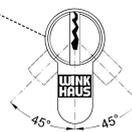
Einbaubereich des Schließzylinders ohne Umstellung des Schließbartes.
