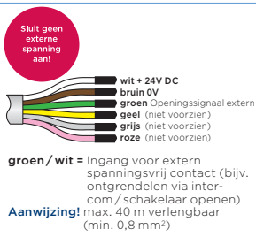
Afbeelding 3.6.3-2: Bekabeling blueMotion+ met stotercontact en "Vingerscanner ekey dLine en kozijnvoeding" (vleugelzijde)
