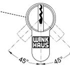
Einbaubereich des Schließzylinders ohne Umstellung des Schließbartes.
