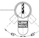
Einbaubereich des Schließzylinders ohne Umstellung des Schließbartes.
