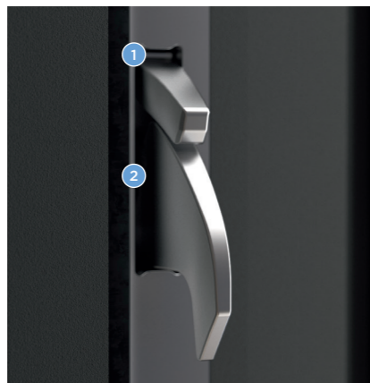
Deur gesloten: Dichtheidselement geactiveerd, haakschoot schuift uit en grijpt diep achter de sluitlijst in.
